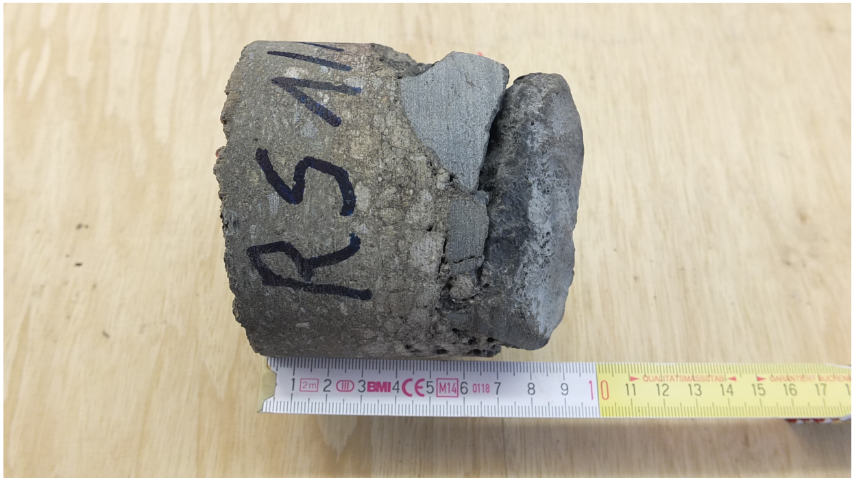
Abb. 1: Asphaltkern RS 1, d = 0,04 m über angespritztem Schotter
